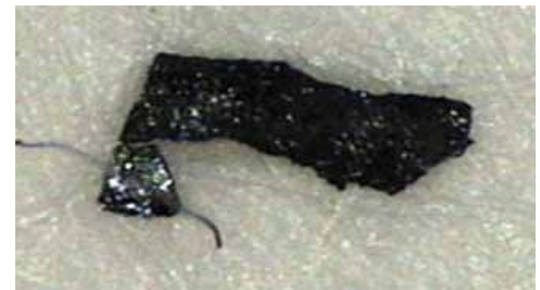
Abb. 34: Nichtmetallischer Partikel, vermutlich Grat oder Kunststoffrest (217 µm)
