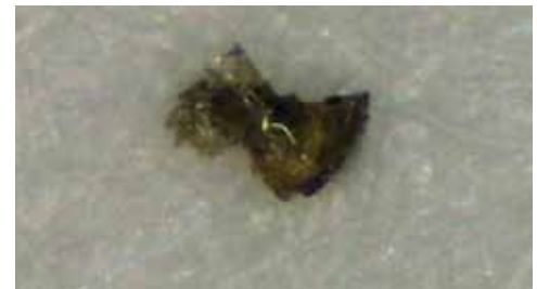
Abb. 35: Nichtmetallischer Partikel, vermutlich Verpackungsmaterial, rosa Schaumstoff'
