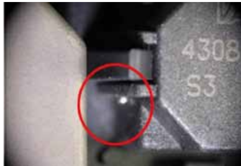
Abb. 30, 31: Eine in ein Kunststoffgehäuse eingeschmolzene Lotperle
