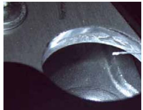
Abb. 69: Stanzreste durch Beizen gelöst
