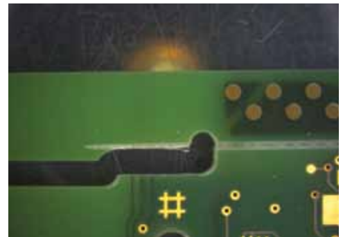
Abb. 58: Ritzstrecke liegt auf Fräskante
