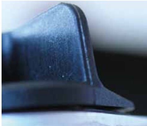
Abb. 70: Kunststoffelement mit Grat
