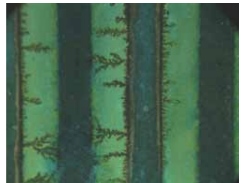
Abb. 104: Dendritenbildung zwischen einer Kammstruktur auf einer Leiterplatte
