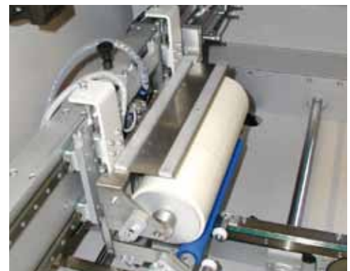
Abb. 86: Adhäsionsrolle für die Durchlaufreinigung von Leiterplatten
