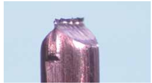
Abb. 23: Seitenschneider-Schnitt am Kupferdraht D = 2,25 mm, Gratbildung
