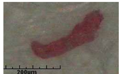
Abb. 35: Nichtmetallischer Partikel, vermutlich Verpackungsmaterial, rosa Schaumstoff'
