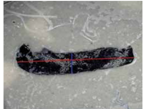
Abb. 71: Partikel von angelieferten Kunststoffelementen
