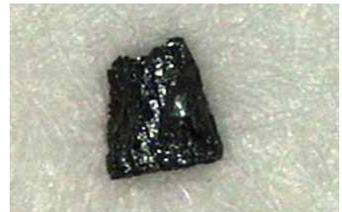
Abb. 33: Ferritpartikel, erkannt als Nichtmetall (558 µm)
