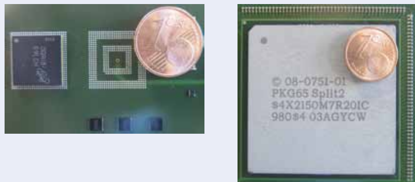
Abb. 55: BGA-Bauformen im Größenvergleich
