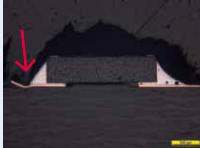
Abb. 99: Padlifting (Querschliffansicht) durch übermäßigen mechanischen Druck
