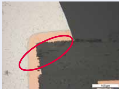
Abb. 93: Laminatriss / von außen nicht sichtbar
