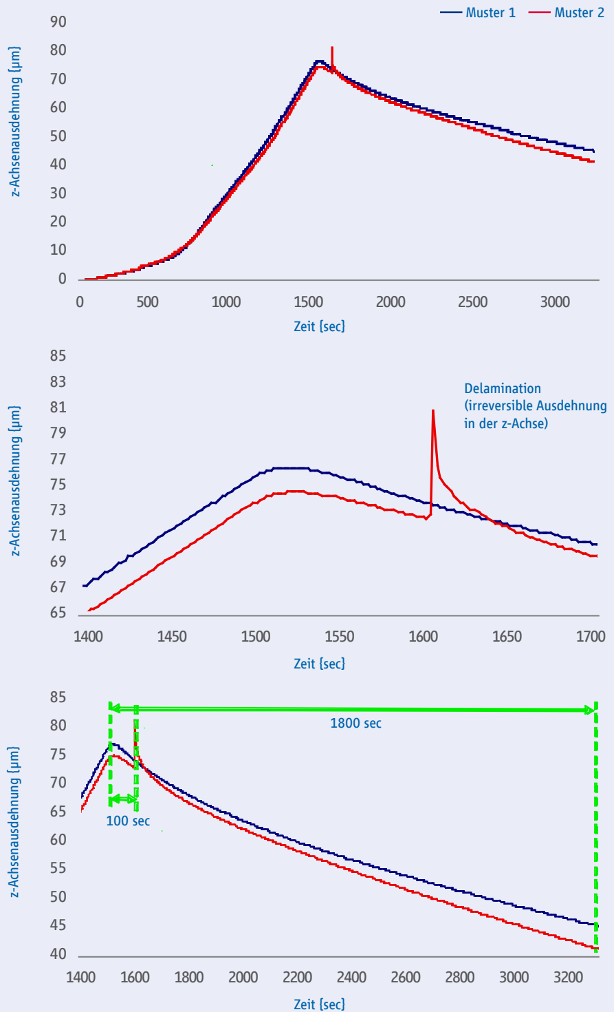
Abb. 6: Auswertung der T_{288} -Werte/Zeiten. In den gezeigten Beispielen erreicht das Muster 1 einen T_{288} -Wert von \geq 30 min (Gesamtmesszeit) und das Muster 2 einen Wert von T_{288} = 1 min 40 sec.
