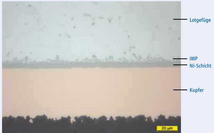
Abb. 70: Intermetallische Phase (IMP) nach 2 × Inline-Reflow + 2 × Nacharbeitssimulation (6 × mit Lötwärme belastet)
