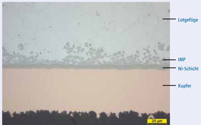
Abb. 71: Intermetallische Phase nach 2 × Inline-Reflow + 5 × Nacharbeitssimulation (12 × mit Lötwärme belastet)
