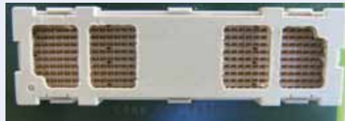
Abb. 57: Array-Steckverbinder mit modifizierter Bestückhilfe
