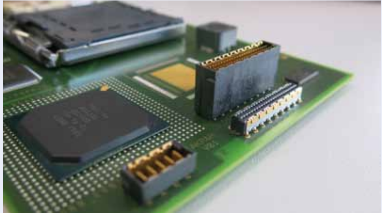
Abb. 53: Steckverbinder mit SMT- und THT-Anschlüssen
