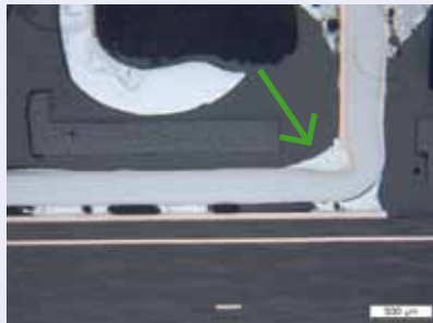
Abb. 101: Elektrolytkondensator, Bauteilkörper unbeschädigt
