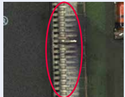
Abb. 105: Unzulässige Flussmittelreste nach manueller Reinigung
