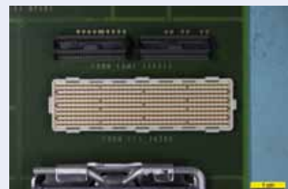
Abb. 64: nach 2 × Inline-Reflow + 5 × Nacharbeitssimulation
