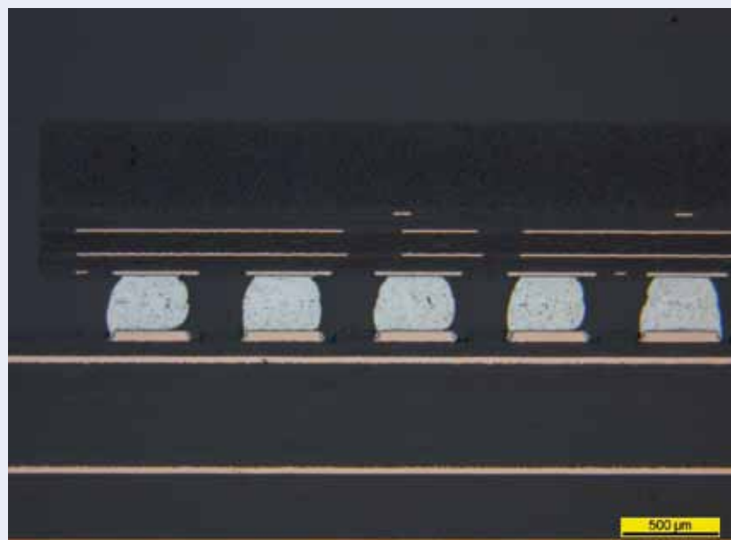
Abb. 87: ZAL R-PBGA-N176, Benetzungsfehler, Übersicht
