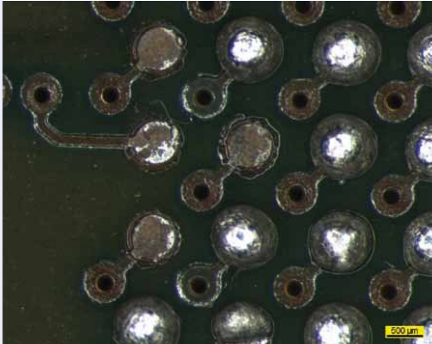
Abb. 109: Lötbarkeitsverlust durch Restlotentfernen
