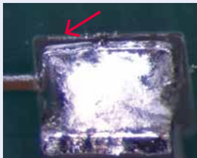
Abb. 97: Padlifting durch zu hohe Lötspitzentemperatur
