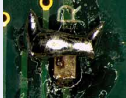
Abb. 104: Exzessive Lot- und Flussmittelmenge, Zapfenbildung an der Lötstelle, Lot berührt unzulässigerweise den Bauteilkörper, verbrannte Flussmittelbestandteile
