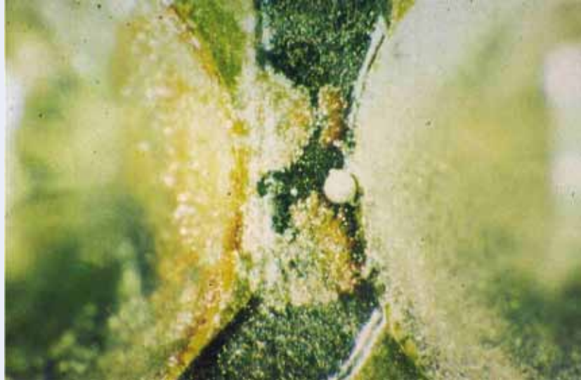
Abb. 119: Dendrite, die Bildung von gelbem und rotem Zinnoxid, weist auf hohe Temperaturen hin
