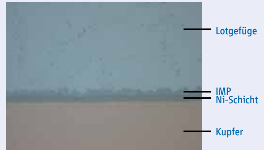
Abb. 26: BGA256TI1.27C, Querschliffanalyse nach Einlöten
