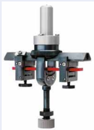
Abb. 14: Drei-Punkt-Biegeaufbau für das DMA. Dies ist jedoch nur eine Möglichkeit von verschiedenen Messaufbauten. Der komplette Messaufbau befindet sich in einem Ofen, der entsprechend den Vorgaben aufgeheizt bzw. auf einer bestimmten Temperatur gehalten werden kann.
