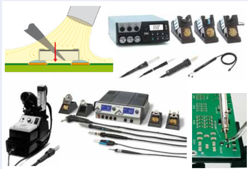
Abb. 36: Heißgas-Lötstationen, wahlweise mit Luft oder inertem Gas zu betreiben
