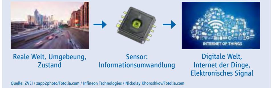
Die weitere Elektronik innerhalb eines Sensors dient dazu, das Sensor-Element mit elektrischer Energie zu versorgen, aber auch dazu, das Signal des Sensor-Elements zu verstärken, bestimmte nicht gewollte Effekte zu kompensieren oder ein analoges Signal in ein digitales zu wandeln. Daneben beinhaltet die Elektronik auch die Kommunikations-Schnittstelle, um das Sensor-Signal an andere elektronische Einheiten weiterzugeben.
