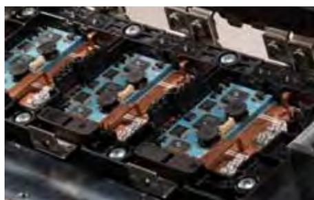
Die Bewertung der Fertigungsqualität basiert auf bekannten MIL- und IPC-Richtlinien (MIL883, IPC610). Die hervorragenden Wärmeleiteigenschaften des Schaltungsträgers eröffnen darüber hinaus auch Möglichkeiten der Optimierung des Thermomanagements vom Halbleiter zur Wärmesenke, zum Beispiel durch lunkerarmes Löten der Leistungskomponenten in inerter Atmosphäre oder die Direktkontaktierung des gesamten Schaltungsträgers an den Kühlkörper.
