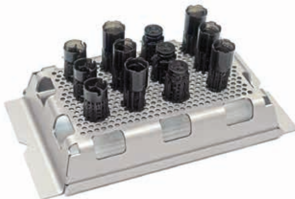
Abb. 1: Isoliergehäuseprototypen eines Rundsteckverbinders auf der Bauplattform eines 3D-Druckers
