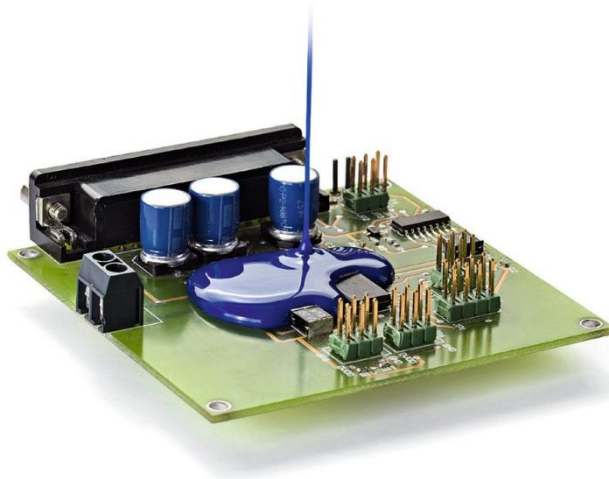
Abbildung 10: Vergießen dient nicht nur zum Schutz der Schaltung, sondern kann auch für eine Verbesserung der Wärmeableitung genutzt werden. (Bildquelle WEVO)
