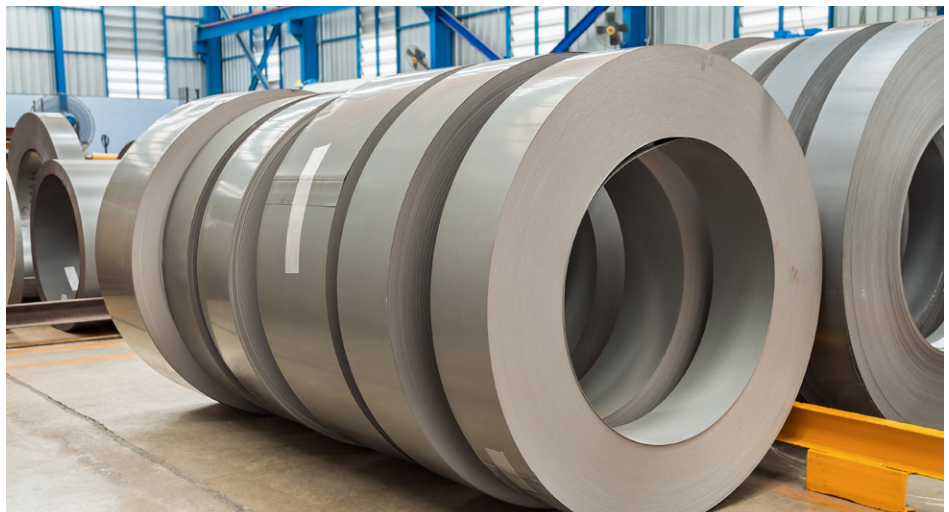
Abb.1: Fertiges Elektroband aus dem durch in weiteren Arbeitsschritten dann durch Stanzen die Elektroleche hergestellt werden.
