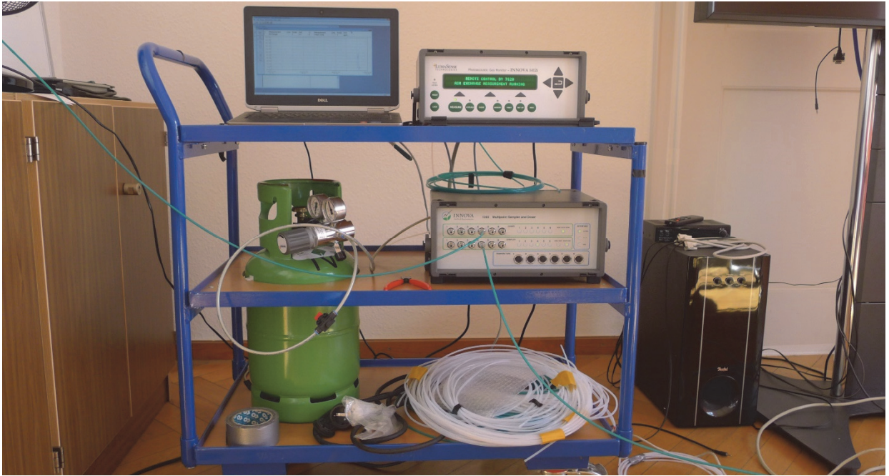
Abb 44: Mobiles Tracergasmessgerät im Konferenzraum (Versuchsaufbau).
